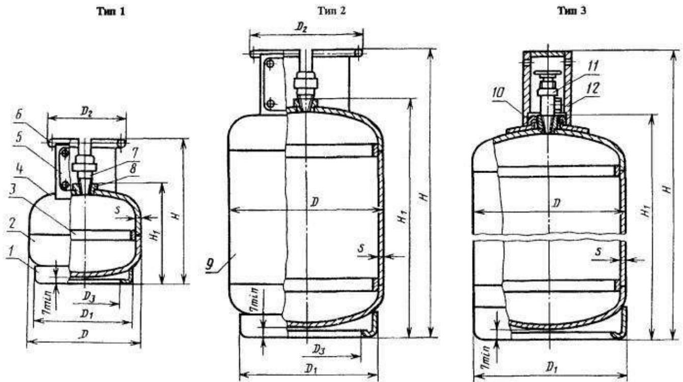
Илл. 3. Устройство баллонов объемом 5, 27 и 50 л:
